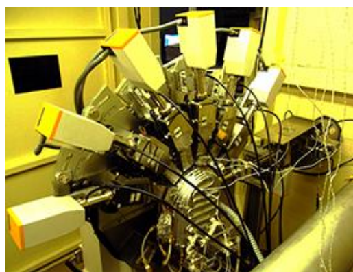
写真 2 : SPring-8 の BL-19B2 に設置されている放射光 X 線回折計の写真(左)および KEK の PF の BL-4B2 に設置されている放射光粉末回折計 (右)。
