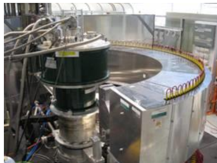
写真 1 : J-PARC における中性子回折計 iMATERIA(左)と ANSTO における中性子回折計 Echidna(右)の写真。
