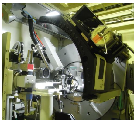
写真 2 : SPring-8 の BL-19B2 に設置されている放射光 X 線回折計の写真(左)および KEK の PF の BL-4B2 に設置されている放射光粉末回折計 (右)。
